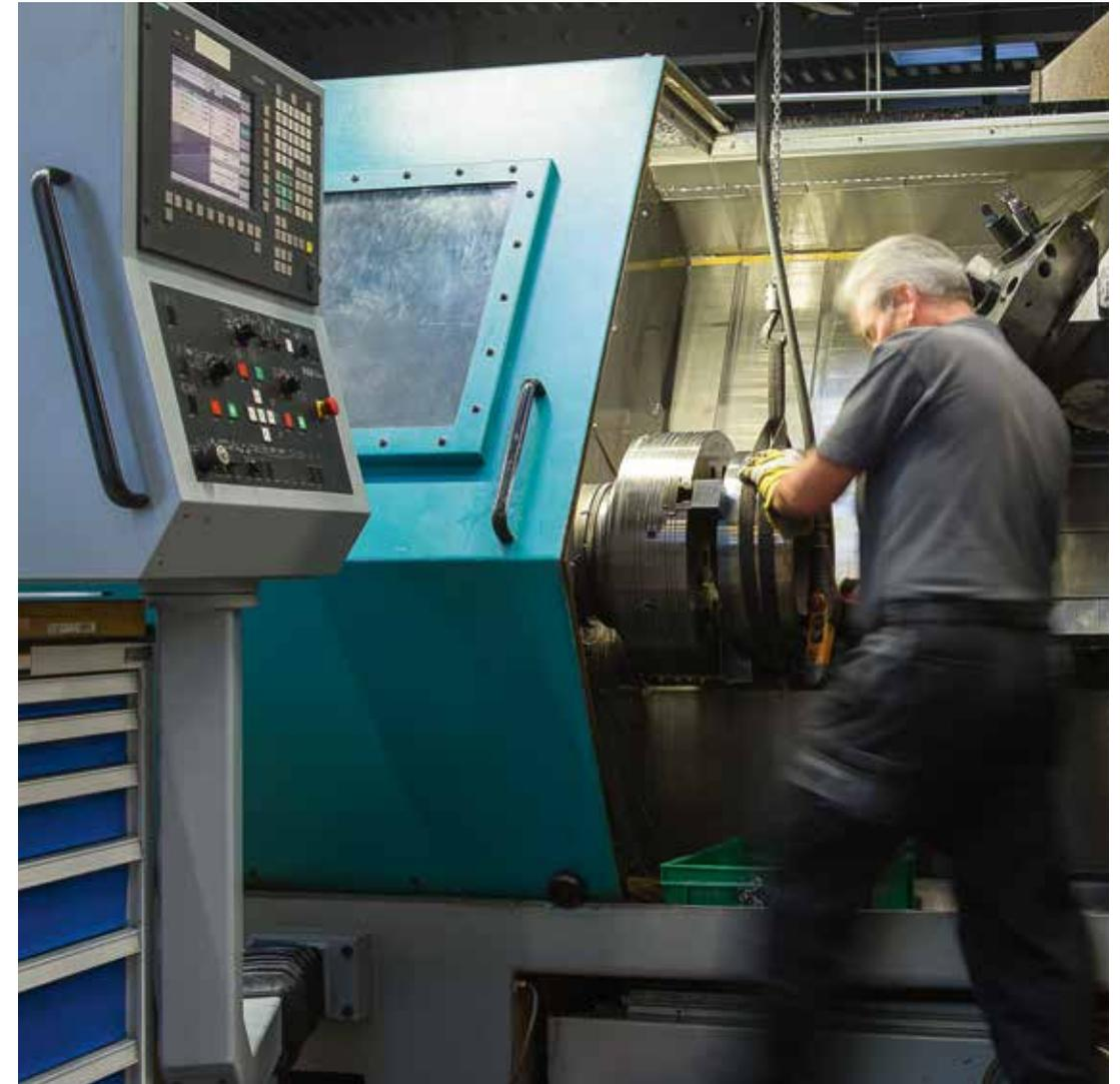
→ Bei Rund- und Planläufen schaffen die CNC-Dreh-Fräs-Zentren eine Genauigkeit von wenigen Mikrometern. The CNC turning/milling centers attain axial and radial run-out accuracy of a few micrometers.
